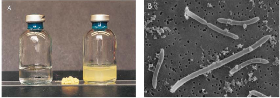
Şekil 32. As_2S_3 çökeleği oluşmadan önce ve sonra kesikli reaktöre ait fotoğraf (A) ve D. auripigmentum 'un 8 günlük inkübasyondan sonra As_2S_3 çöktürdüğünü gösteren taramalı elektron mikroskobu görüntüsü
