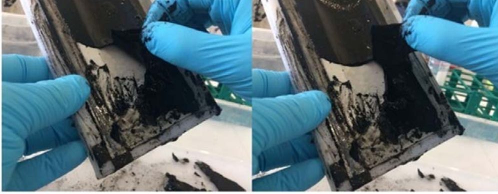
Şekil 20. AnMBR'de kek sıyrılması sırasında çekilen görseller
