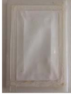
Şekil 7. Çalışmada kullanılan temiz membran modülü
