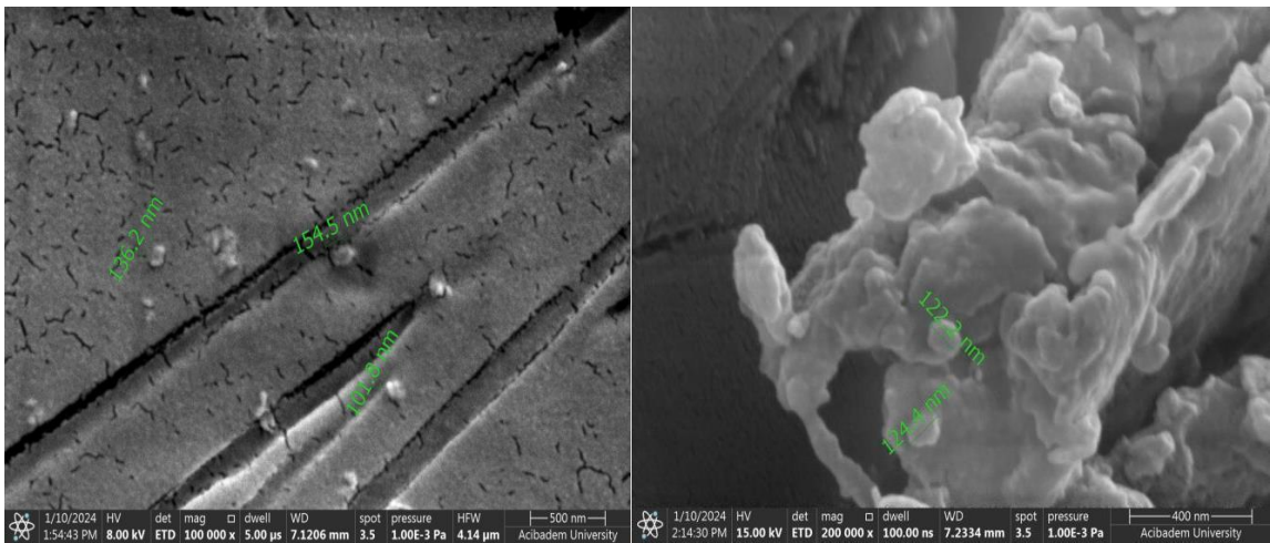
Şekil 3.20. (A) tiyolsüz ve (B) tiyollü PEG-10K Np'lerin SEM görüntüleri
