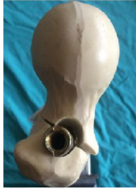
Şekil 4.1: Aksiyel Yüklenme Sonrasında, Proksimal Kırık Hattı Oluşan A-PFN Uygulanan Kemik Modeli
