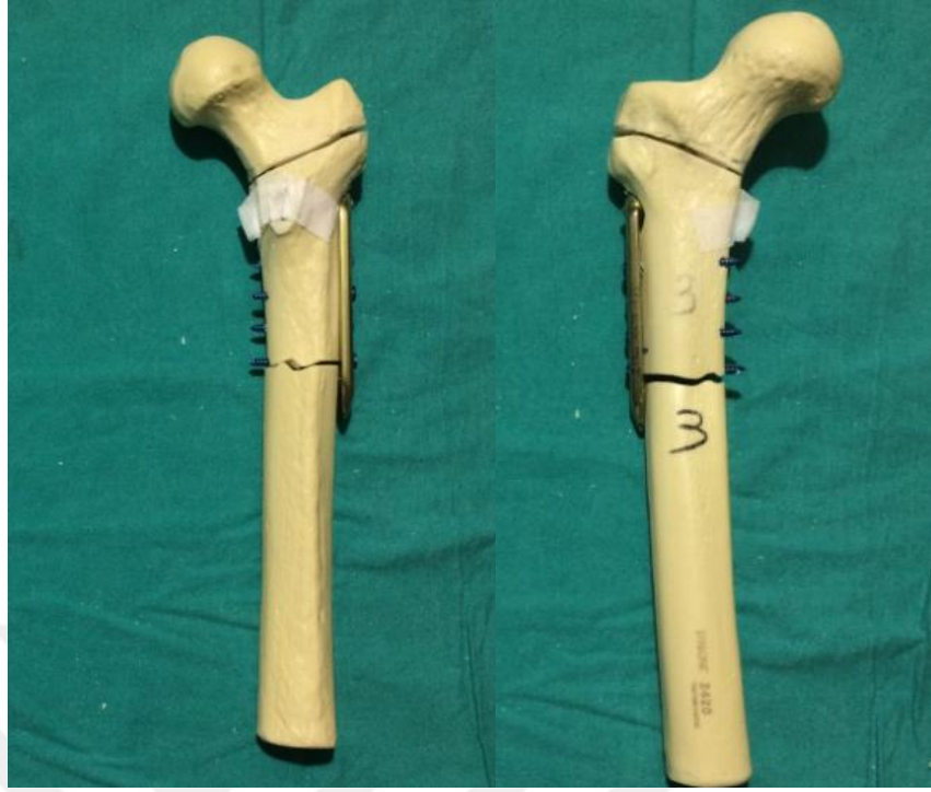
Şekil 4.4: Aksiyel Yüklenme Sonrasında, A-DHS Uygulanan Grupta Transverse Kırık
