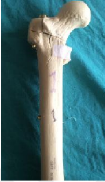
Şekil 4.1: Aksiyel Yüklenme Sonrasında, Proksimal Kırık Hattı Oluşan A-PFN Uygulanan Kemik Modeli
