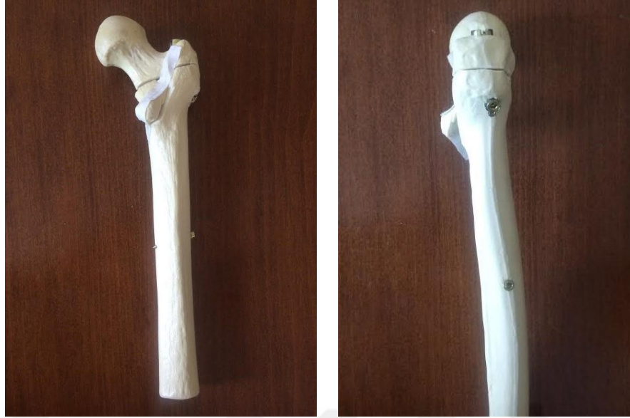
Şekil 3.6: A-PFN ile Fikse Edilmiş İntertrokanterik Femur Kırıklı Kemik Modeli Anterior ve Lateral Görünüm
