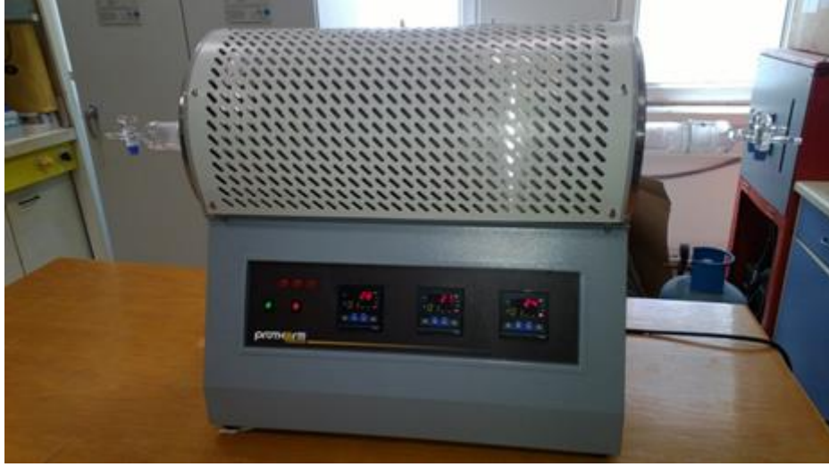
Şekil 6: PVD yöntemiyle nanotel büyütmek için kullandığımız fırın
