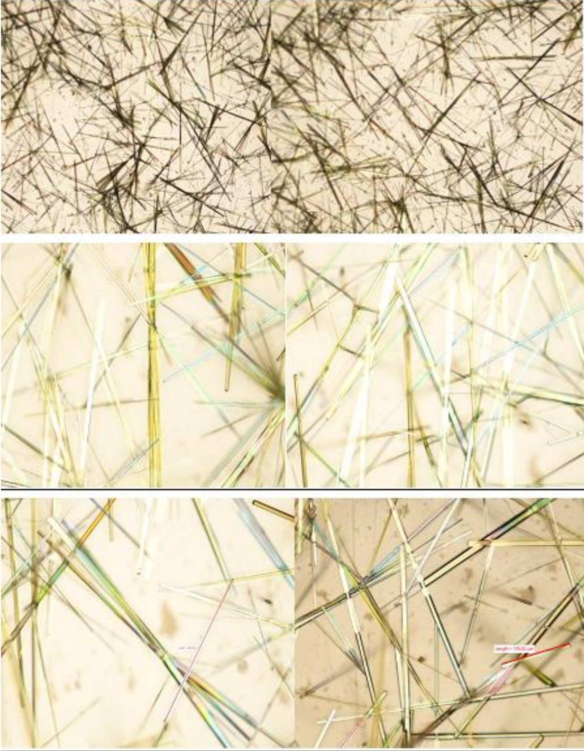
Şekil 24: Alq 3 molekülünden nonsolvent nucleation yöntemiyle üretilen mikrotellerin optik mikroskop görüntüleri.
