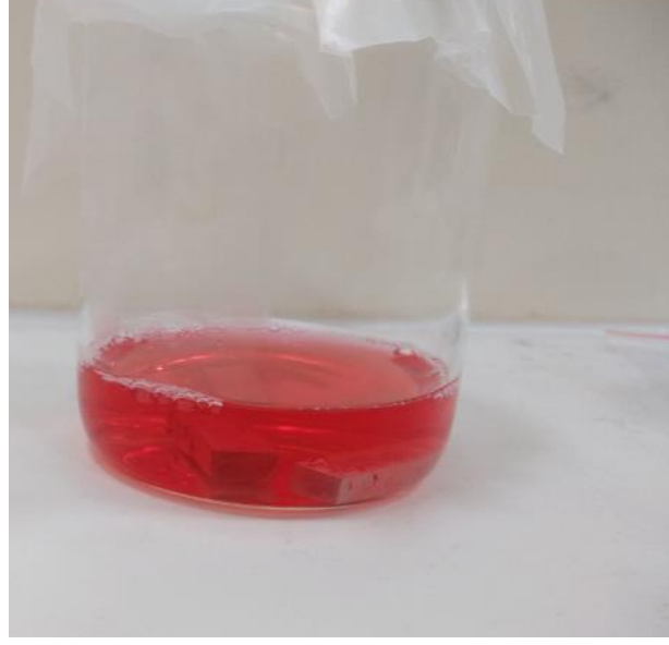
Şekil. 31 Yukarıda ki şekilde, %3.5 NaCl içinde korozyona bırakılmış AZ31B numuneleri altta ki şekilde, DMEM içinde korozyona bırakılmış AZ31B numune çifti
