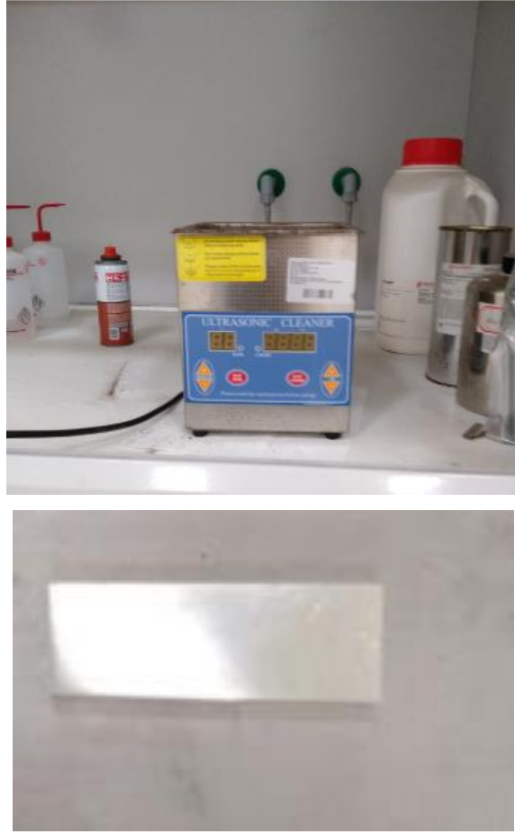
Şekil. 27 Ultrasonik temizleyici ve kaplanmaya hazır AZ31B plaka
