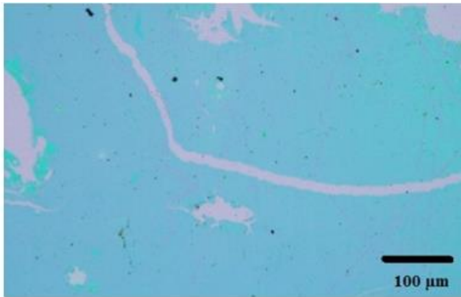
Şekil 2.10 (a) Şekil 3.6e deki Cu filmin çözünmesi ile elde edilen büyük grafen tabakasının optik mikroskop resmi. (b) bu grafen tabakasının Raman spektrumu.
