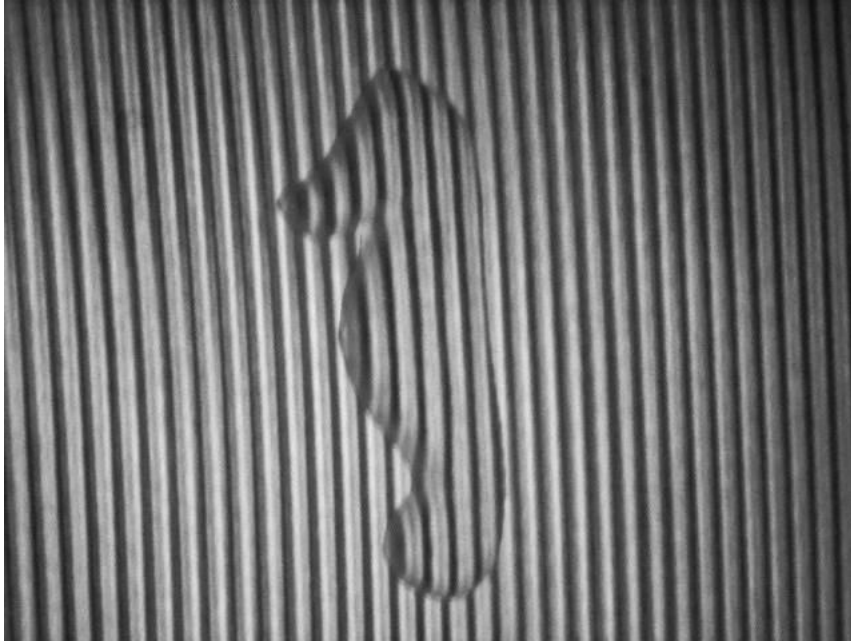
Şekil 3.11 Alçı denizatı cismi kullanılarak L-FPP'den elde edilen ızgara deseni.
