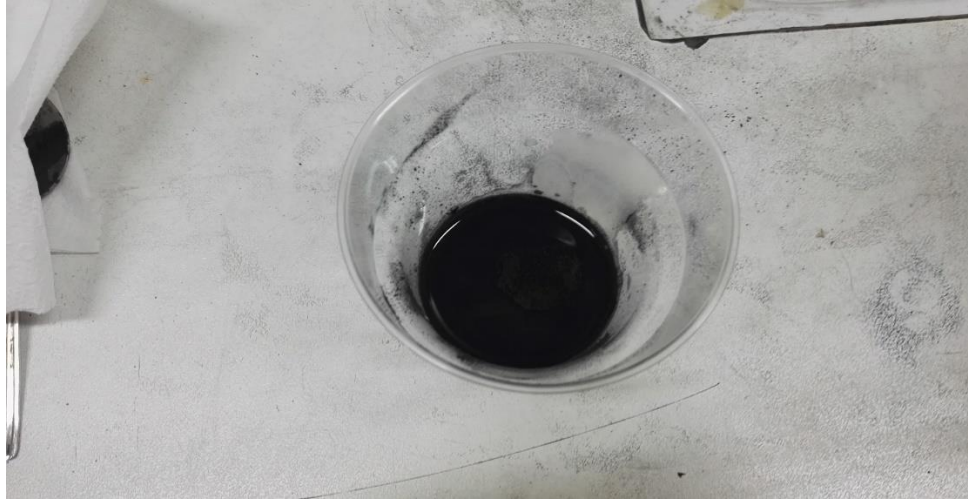
Şekil 28: 6 nm' lik grafen- su karışımı örneği
