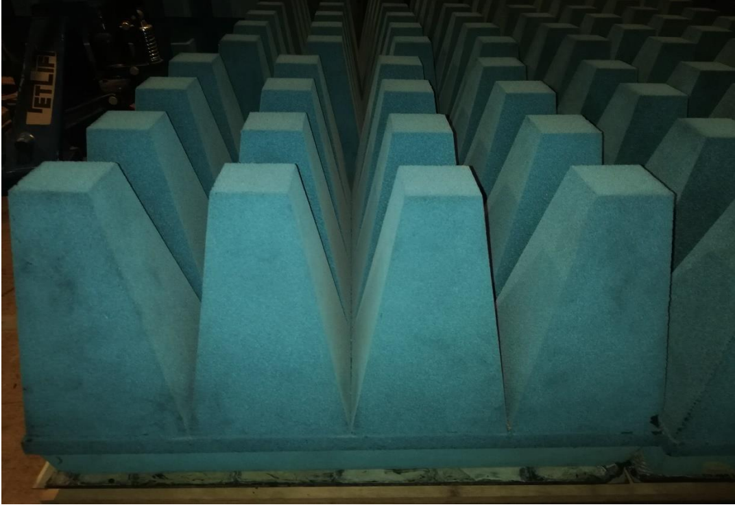
Şekil 15: Hibrid poliüretan soğurucu sünger.
