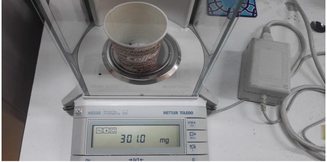
Şekil 25: 3nm' lik grafen gram ölçümü (Ölçüm için örnek)
