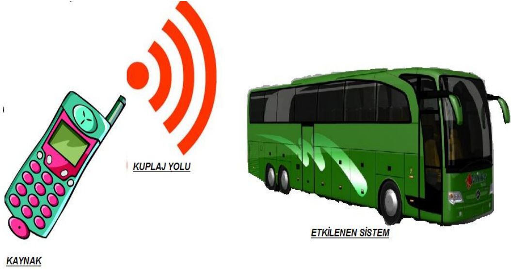
Şekil 4: Otobüslerin fren sistemlerinin cep telefonundan etkilenmesi.
