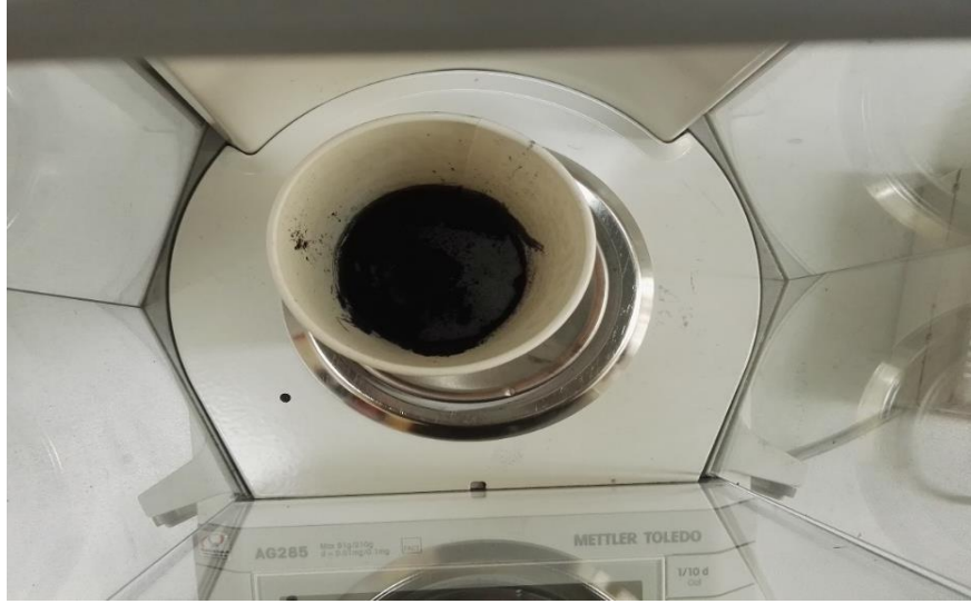
Şekil 30: Epoksi boya- grafen karışımı örneği
