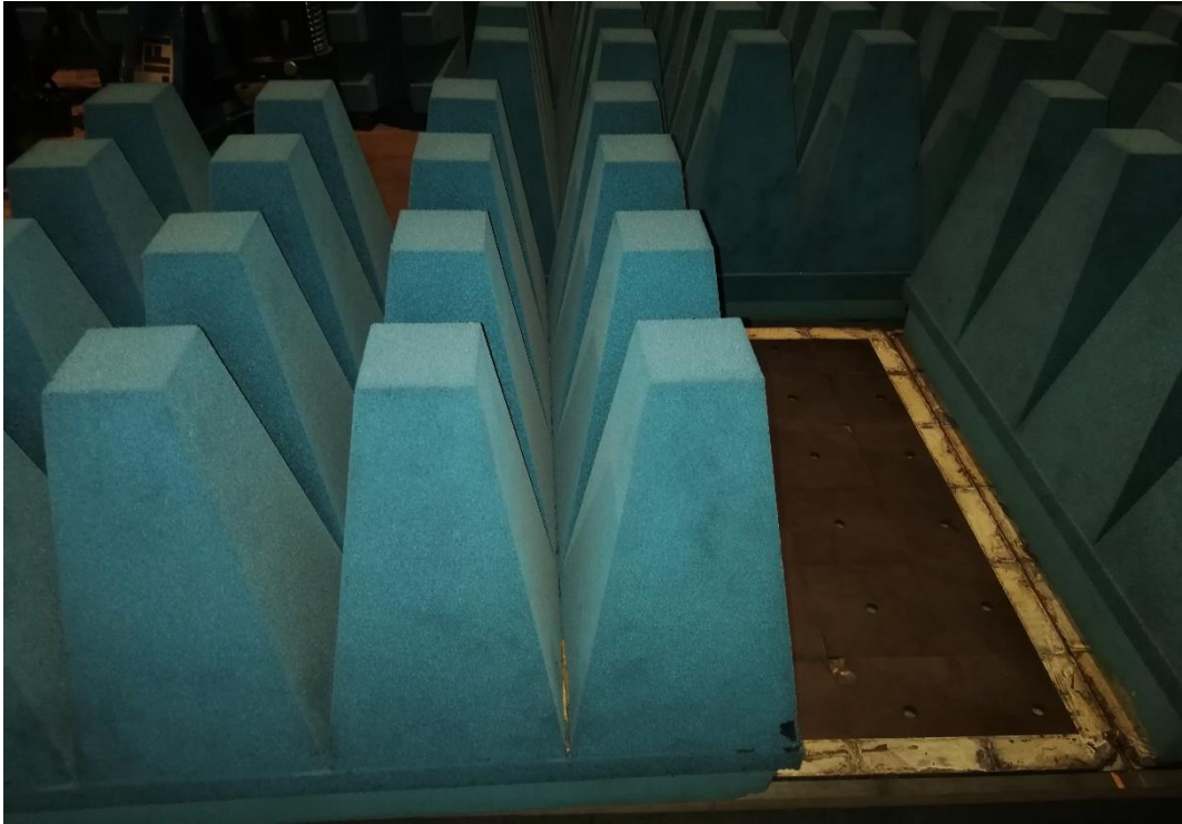
Şekil 16: Hibrid- Ferrit soğurucu.
