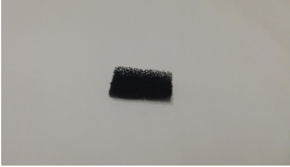
Şekil 39: Oluşturulan 3 nm poliüretan soğurucu sünger
