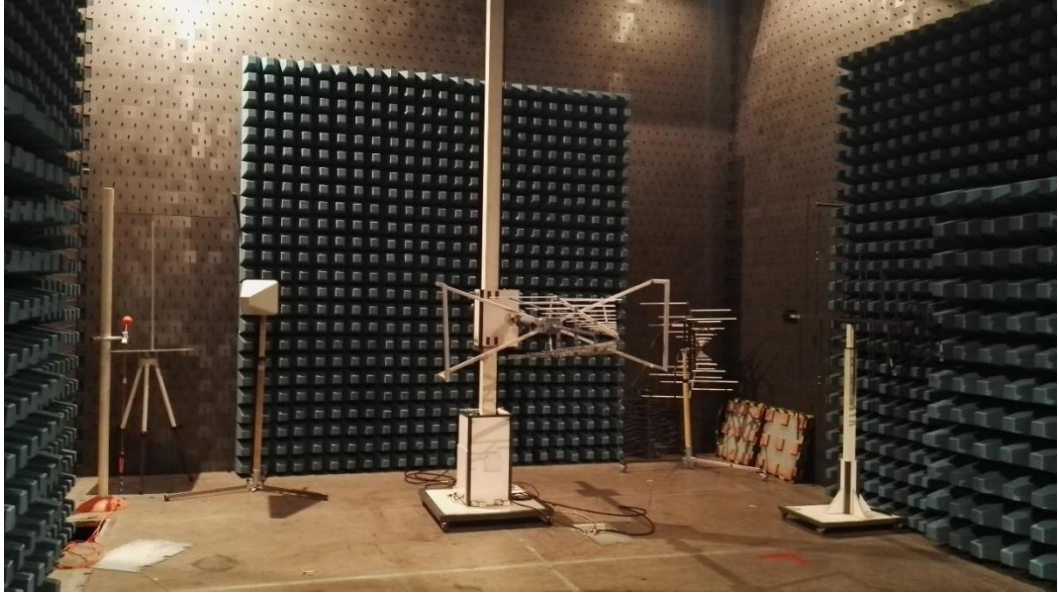
Şekil 9: TSE yansımaz oda
