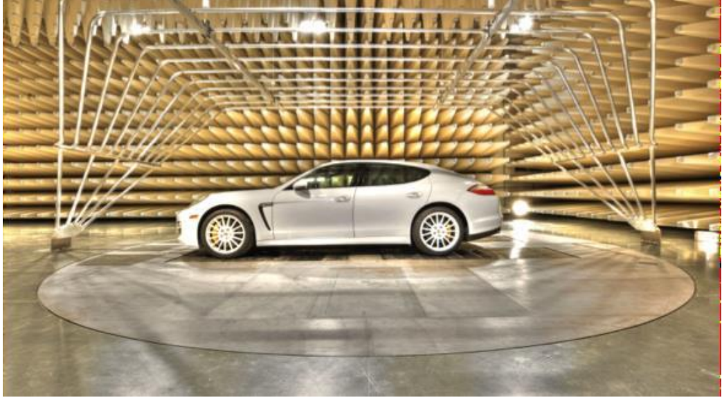
Şekil 8: Otomotiv testleri için kurulmuş yansımaz oda
