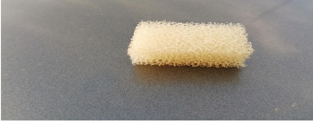
Şekil 24: 5-6mm kalınlığında kesilmiş poliüretan soğurucu sünger örneği
