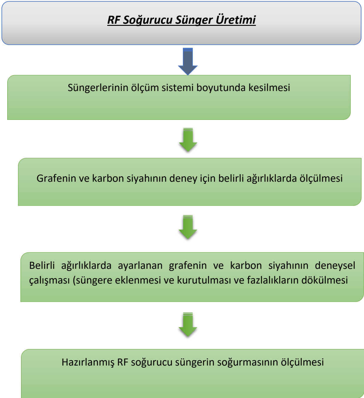
Şekil 23: Grafen içerikli nano kompozit RF soğurucu süngerlerin üretimi ve RF soğurma özelliklerinin ölçümünde takip edilen yöntemin şematik gösterimi
