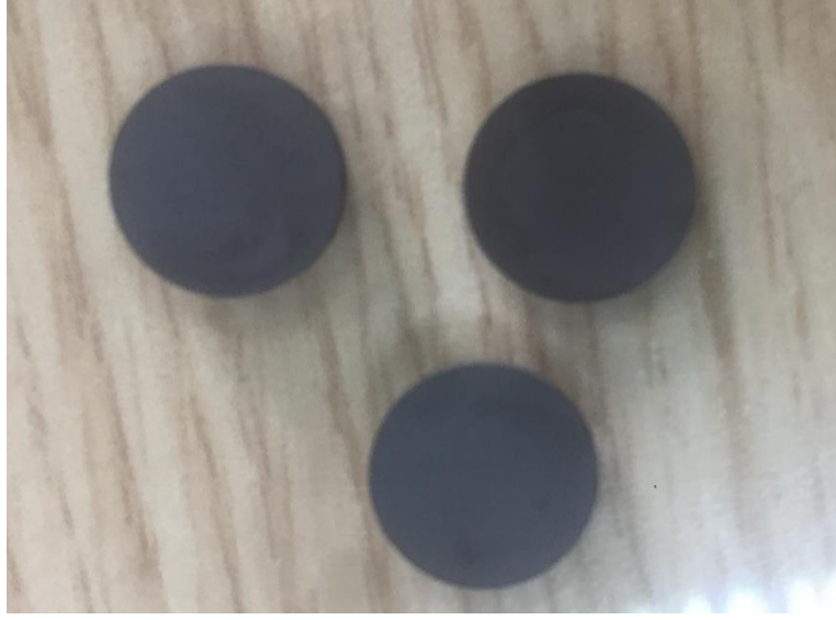
Şekil 3.1 %1 Pd katkılanmış \text{LaCrO}_3 malzemesinden hazırlanmış pelletler
