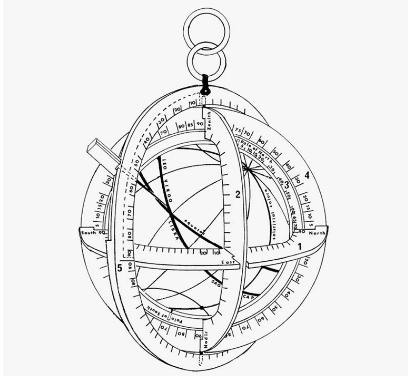
Resim 3. Bettānī'nin küre dizaynı. 1. ufuk halkası, 2. zenit halkası, 3. hareketli meridyen halkası, 4. sabit meridyen halkası, 5. gnomonu taşıyan dış halka (Savage-Smith ve Belloli, 1985: 21).
