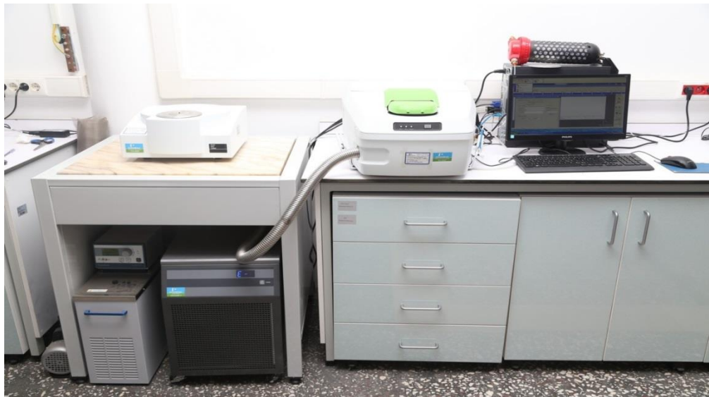
Şekil 27. Diferansiyel Taramalı Kalorimetre ve Termogravimetrik Analiz Cihazı [(PERKIN ELMER DSC 8500) & (PERKIN ELMER STA 6000 DTA-TGA)]
