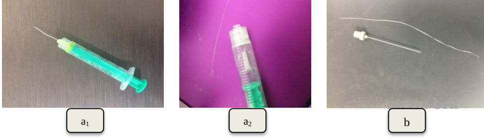
Şekil 22. a) a 1 ve a 2 'deki görselde enjektör ile içerisinde donmuş solüsyon gözlemi, b) Kanül iğne ucu ve içerisinde donmuş solüsyonun çıkarıldıktan sonraki görüntüsü
