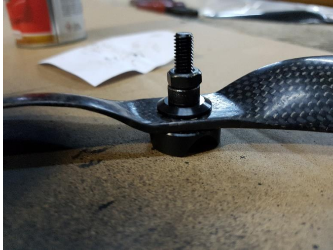
Şekil 18. Pervane adaptörü ve pulun montajlı hali
