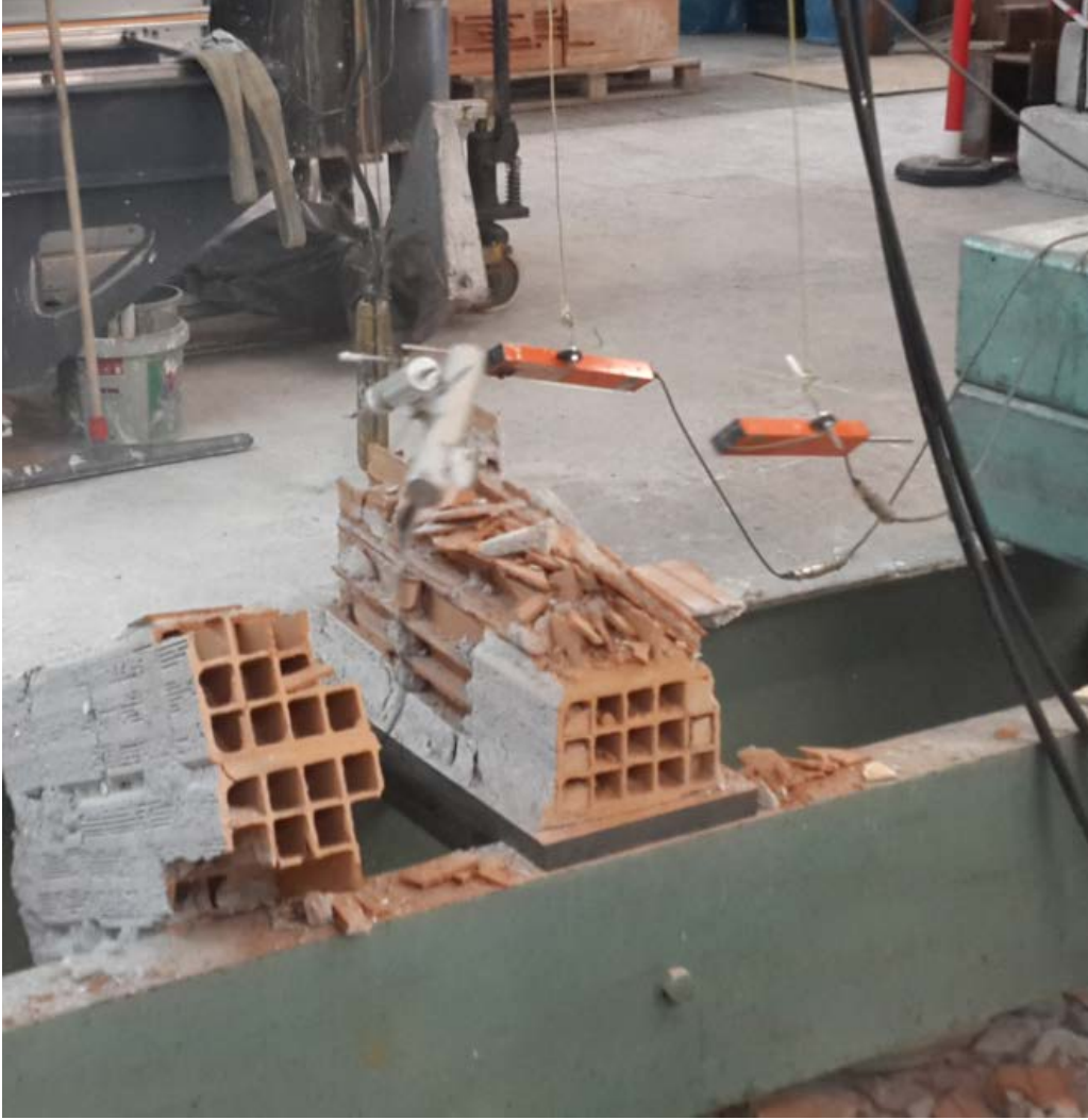
Şekil 33. Basınç yükü etkisinde aniden parçalanmış numune
