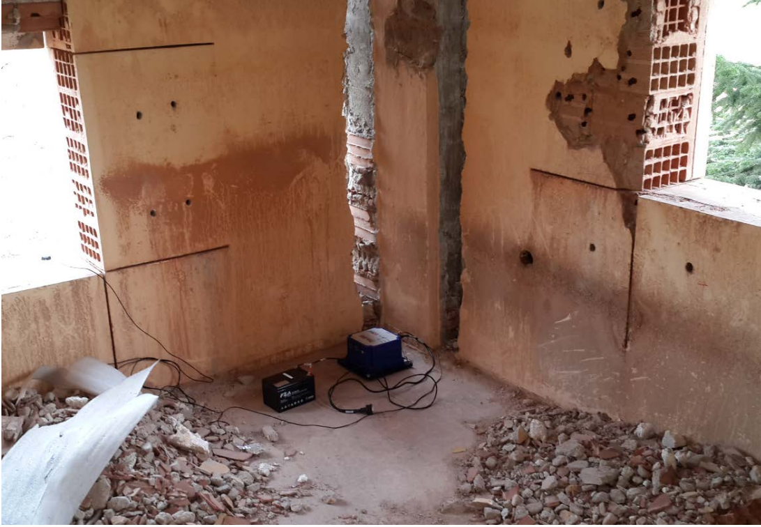
Şekil 39. Zemin katında bölme duvarları etkisizleştirilmiş binadan titreşim kayıtlarının alınması
