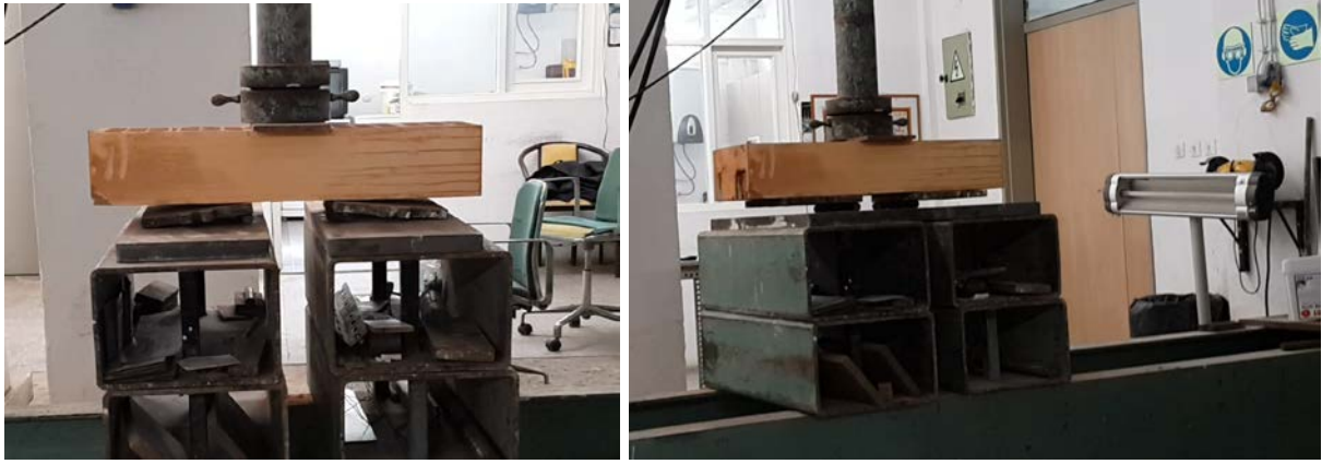
Şekil 36. Laboratuvarında gerçekleştirilen duvar kayma deneyi (Yüklemeden önceki ve yükleme yapılırken alt levha konumları farklı)
