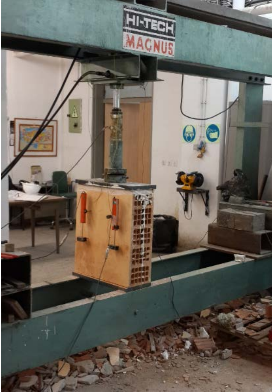
Şekil 32. Laboratuvarda gerçekleştirilen duvar basınç deneyi
