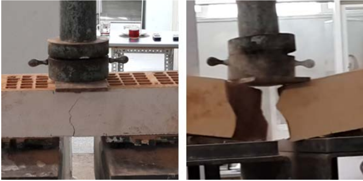
Şekil 38. Kayma deneyi sonunda oluşan tuğla kırılması
