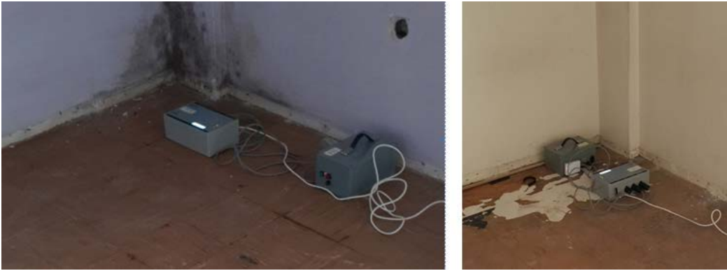
Şekil 23. Tek eksenli ivmeölçerler ile yapılan dinamik tanımlama
