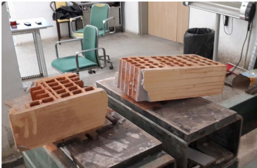
Şekil 37. Kayma deneyi sonucunda oluşan kayma göçmesi
