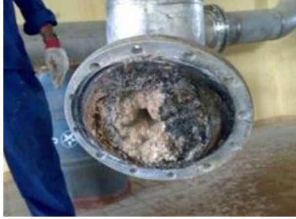
Şekil 1. İstenmeyen strüvit oluşumu sebebiyle tıkanan boru (Fattah, 2012)
