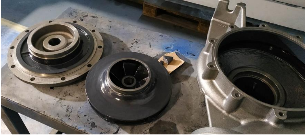
Şekil 8: Kaplama işlemi bittikten sonra kür için bırakılan soldan sırayla gövde kapağı, çark ve salyangoz gövde
