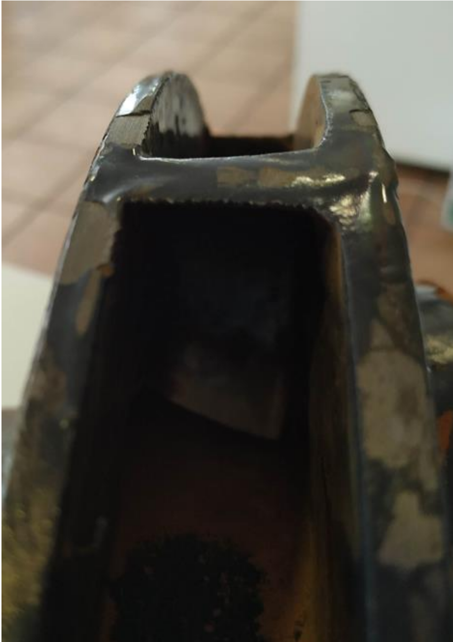
Şekil 29: Deney sonrası kaplama yapılan çarkın uç kısımları
