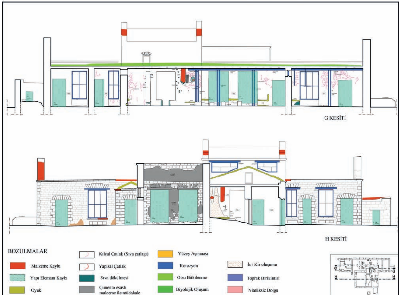
Şekil 12: Yapıdaki bozulmaları gösteren çizimler / Drawings of deteriorations
