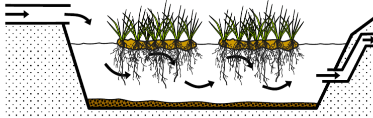
Şekil 2. 1 Yüzen sulak alan sistemi şematik gösterimi (Headley ve Tanner, 2008).
