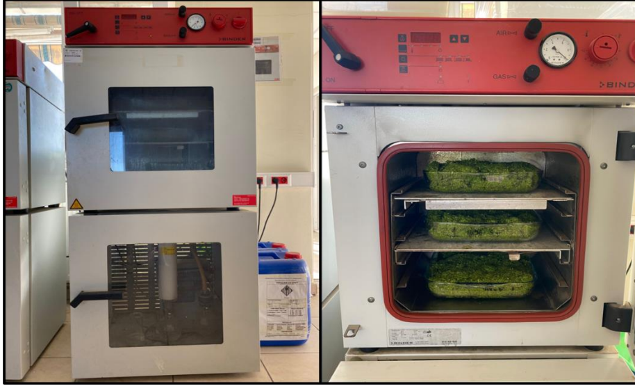
Şekil 3. 7 Lemna minor biyokütlesinin kurutulduğu vakumlu etüv
