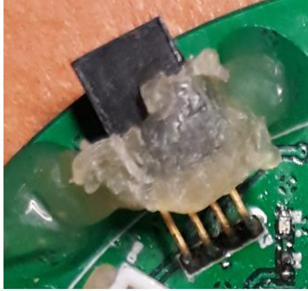
Şekil 25. İşlemciye yazılım atılan JTAG pini.
