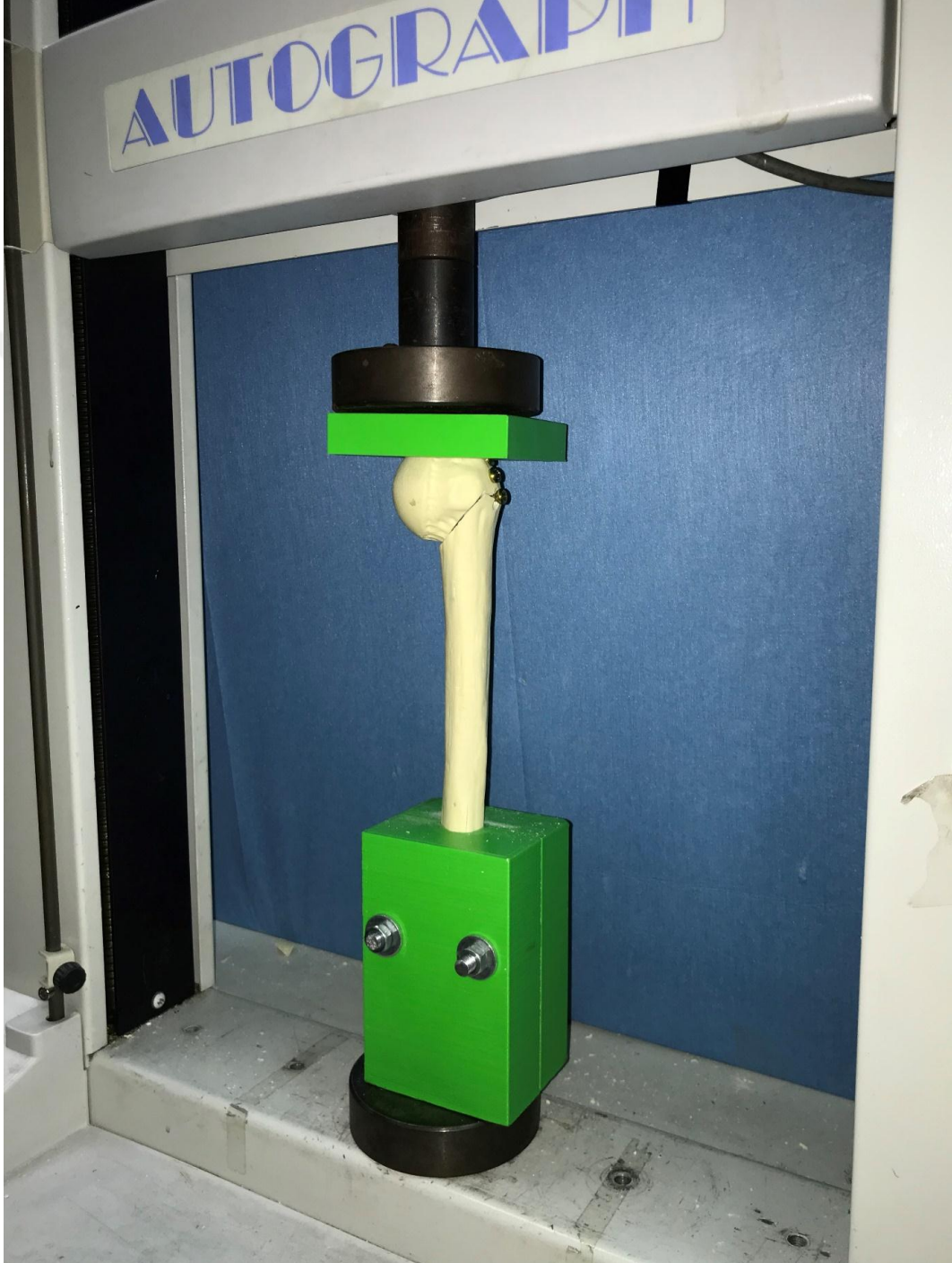
Şekil 4.4: İMÇ uygulanmış bir numunede yüklenme testi esnasında kırık hattında oluşan kollaps
