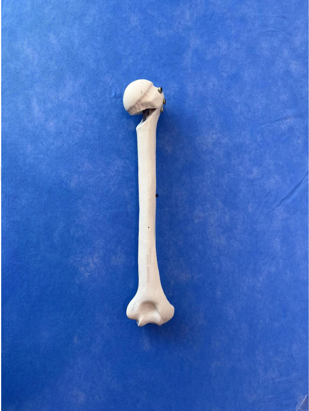
Şekil 3.13: Distal kilitlemenin statik vida ile yapıldığı İMÇ uygulanmış kemik modeli
