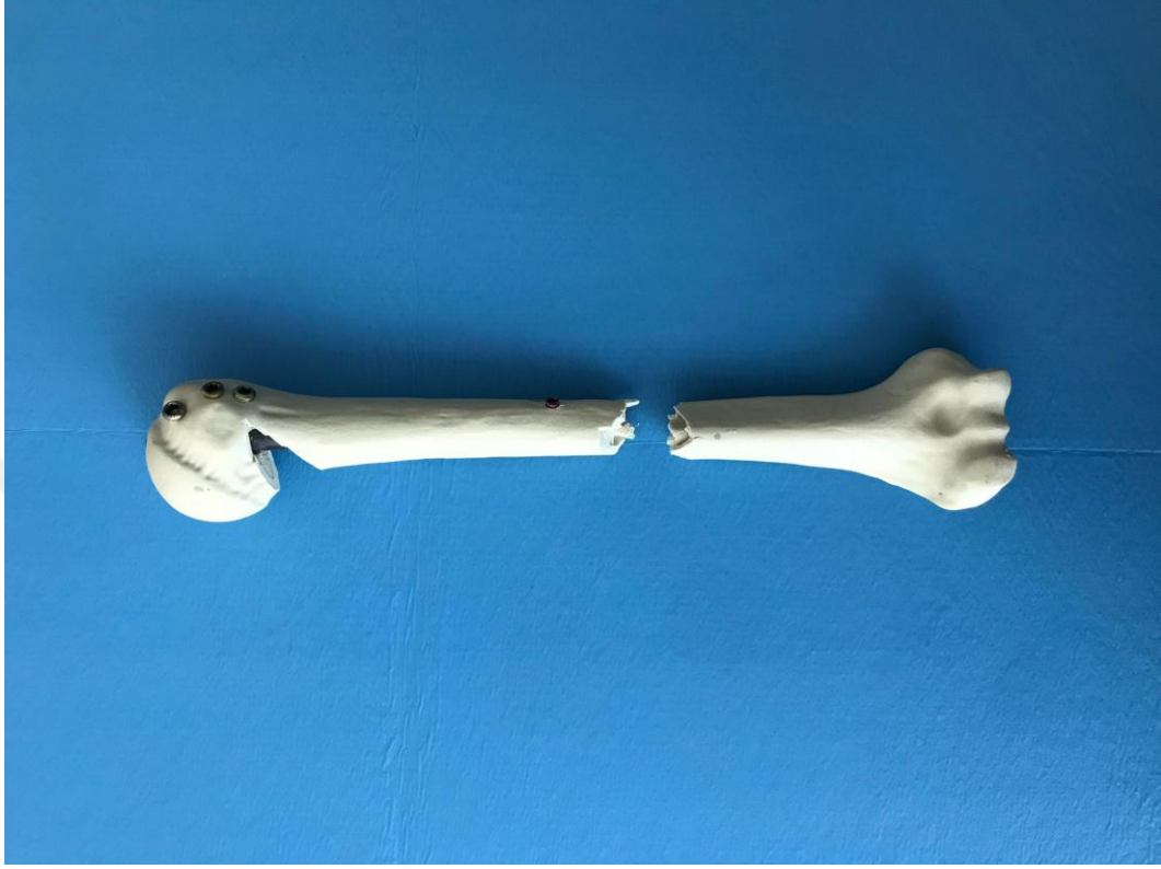
Şekil 4.6: İMÇ uygulanmış kemik modellerde yüklenme ile oluşan transvers seyirli kırık
