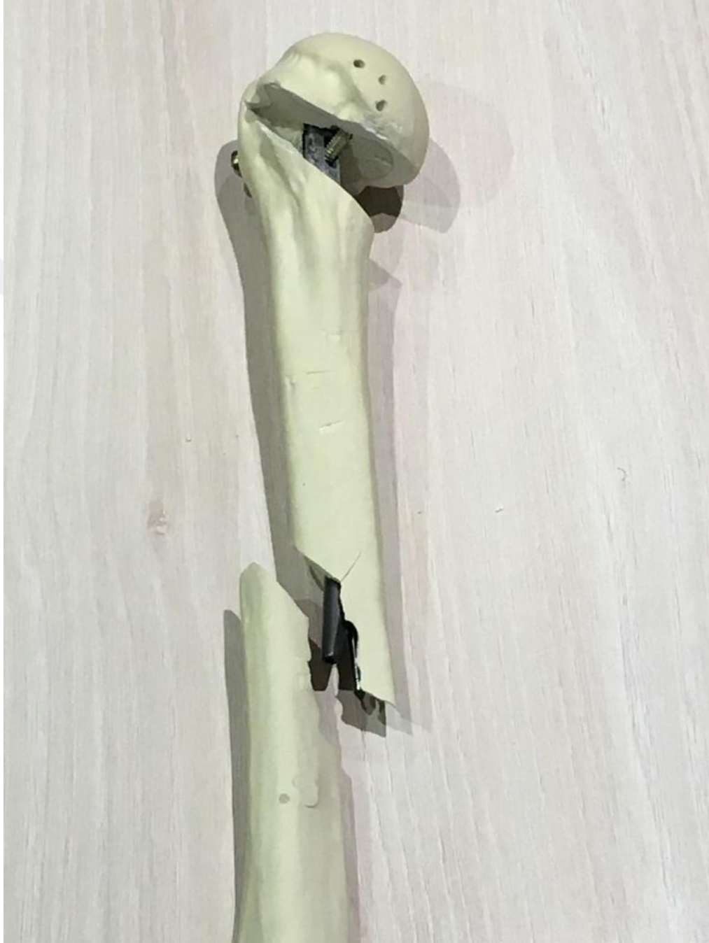
Şekil 4.5: Distali endopin ile kilitlenen İMÇ uygulanmış bir numunede yüklenme testi ile oluşan çivi distalinde oblik seyirli kırık
