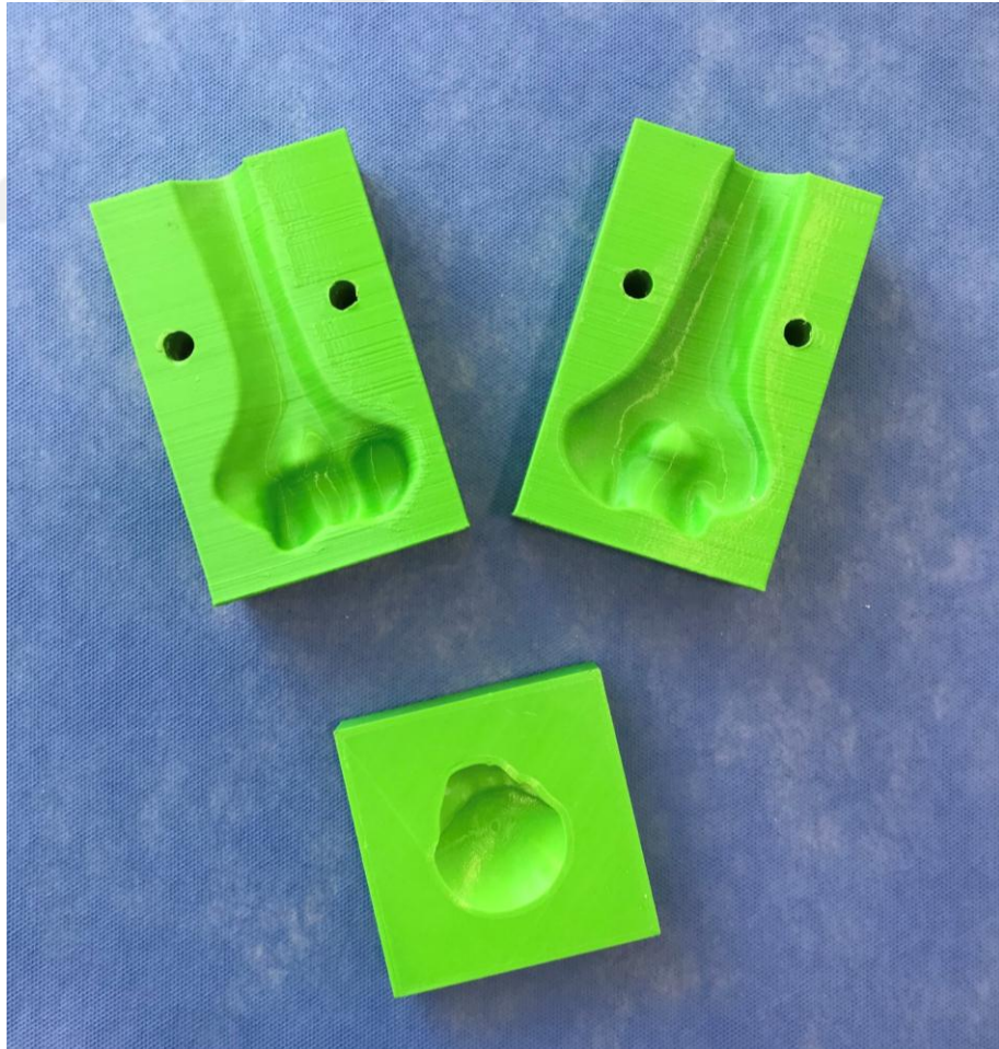
Şekil 3.15: Humerus modellerinin test cihazına adaptasyonu için oluşturulan ara yüzler
