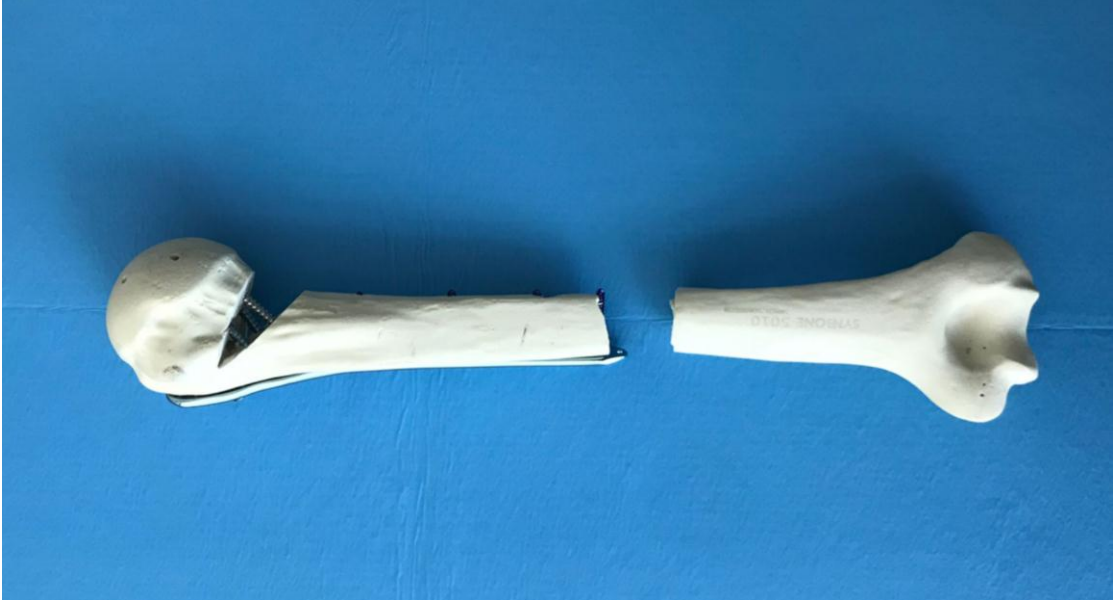
Şekil 4.1: Lateral anatomik plak uygulanmış numunenin yüklenme testi sonrası kırık hali
