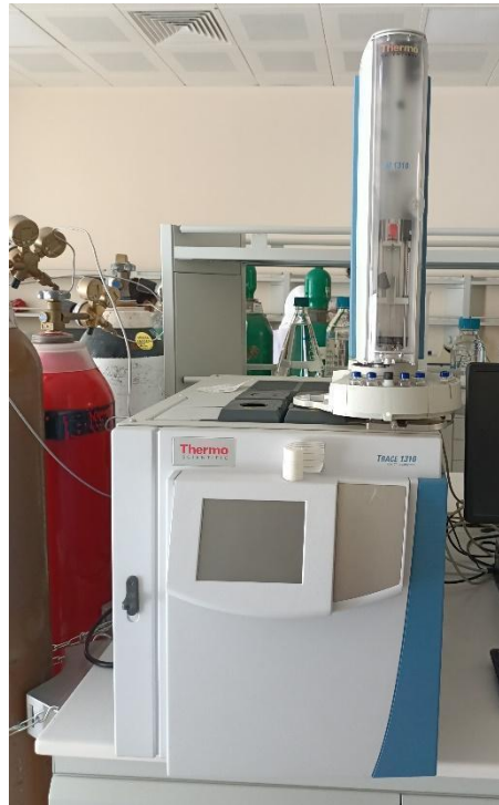
Şekil 11. Trace 1310 gaz kromatografisi (Thermo Scientific) görüntüsü
