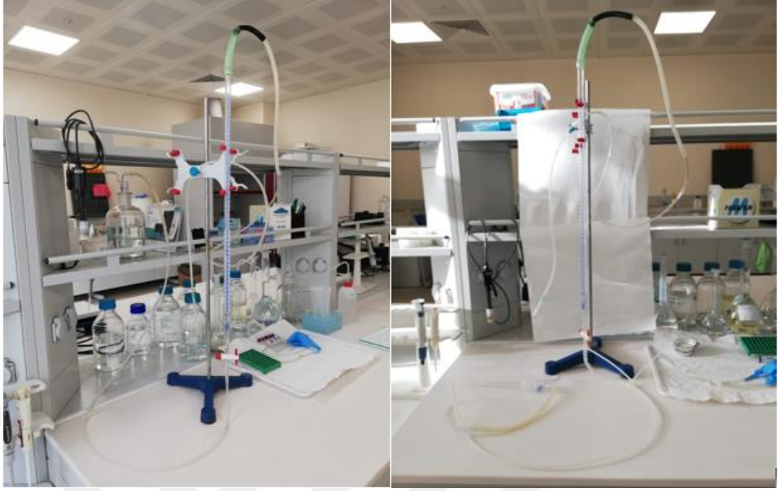
Şekil 10. BMP testlerinde üretilen metan miktarının ölçülmesi için kullanılan düzenek
