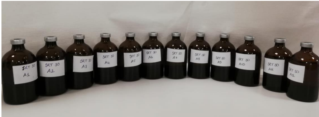
Şekil 9. BMP deney setini gösteren bir fotoğraf
