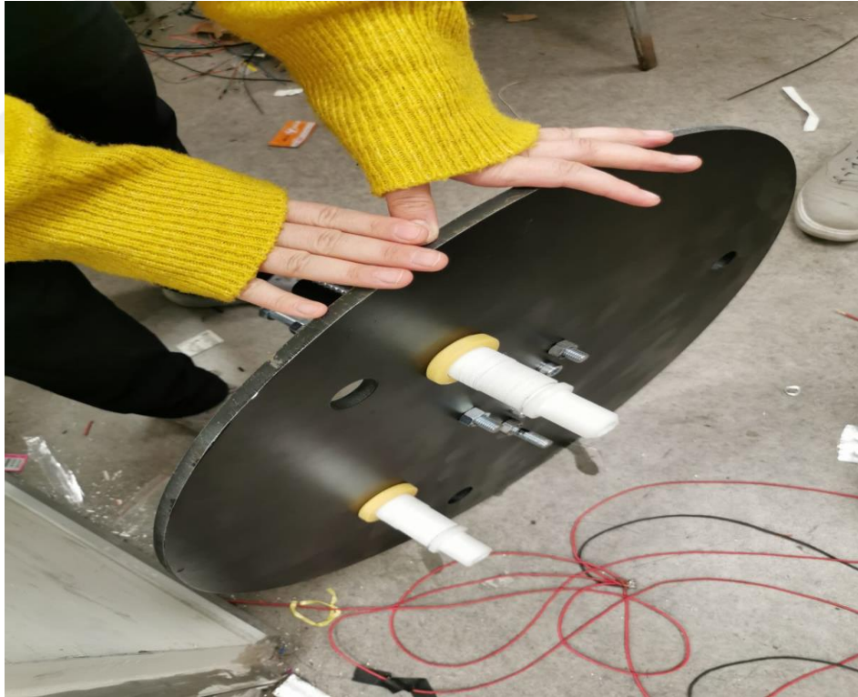
Şekil 2.12. Hortum girişi ve çıkışı için yaptırılan parçalar
