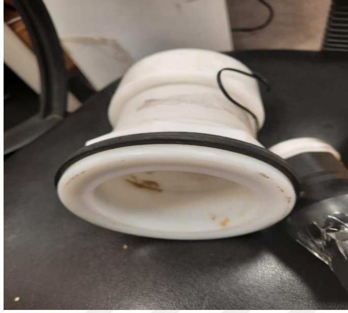
Şekil 2.17. Reaktör çıkış parçası (Sıcaklık sensörü kablosuyla birlikte yaptırılmıştır.)
