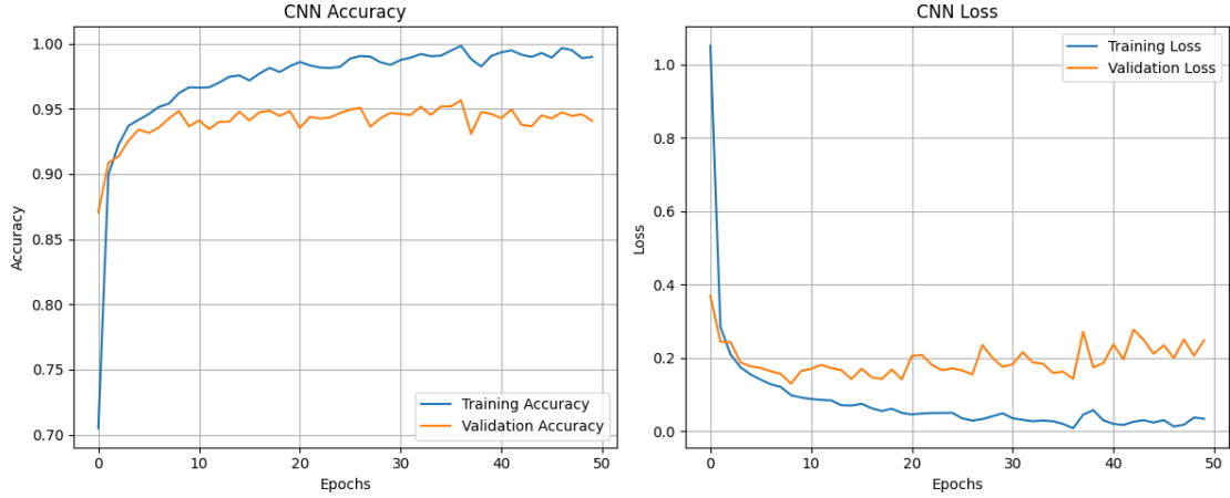
Şekil 4.22 MIMO Sistemlerde CNN Anten Seçim Performansı
