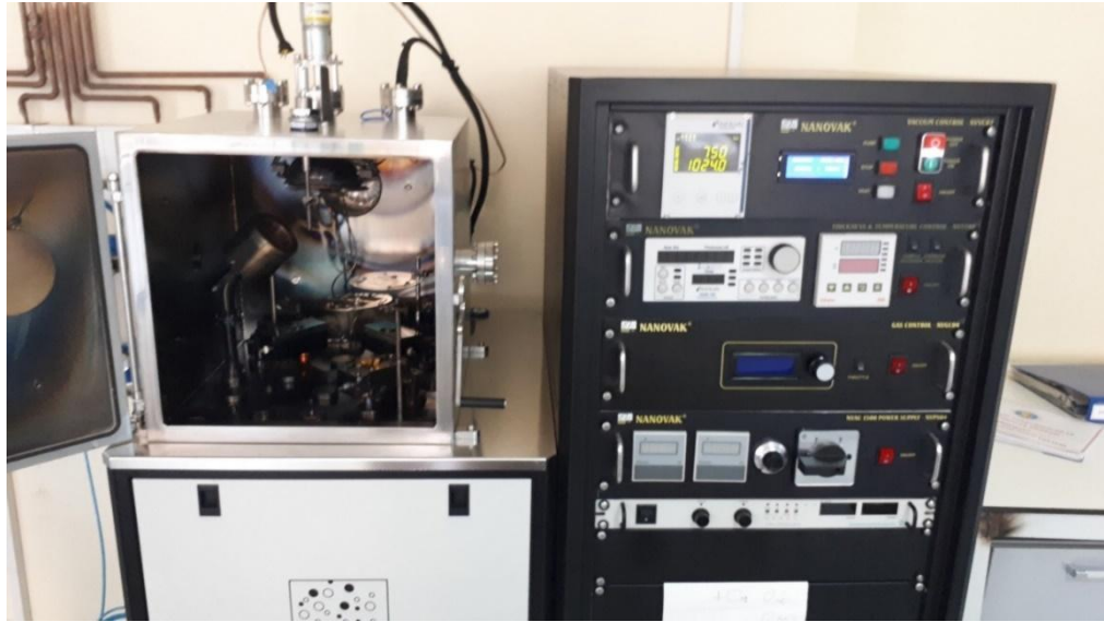
Şekil 3.1 Buharlaştırma için kullanılan vakumlu metal buharlaştırma ünitesi
