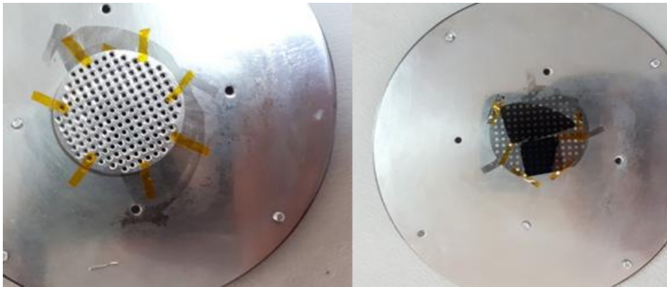
Şekil 3.3 Doğrultucu kontaklar için maske ve maske üzerine konulmuş Si yarıiletken kristal parçaları
