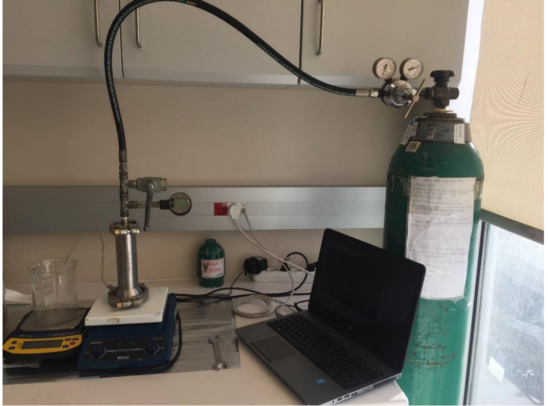
Şekil 15. Ölü sonlu filtrasyon deney düzeneği
