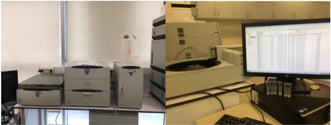
Şekil 22. Dionex ICS-5000 + IC iyon kromatografisi (Thermo Fisher Scientific, USA)
