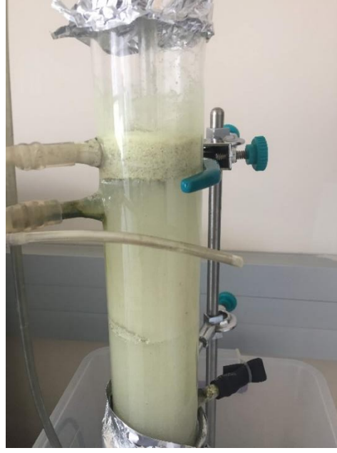
Şekil 13. YAKB’de sıkışan azot gazının serbest kalması neticesinde yataktaki hareketliliğe örnek bir fotoğraf
