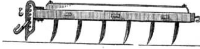
Şekil 93 Valkur'un sürgüsünün yandan görünüşü
