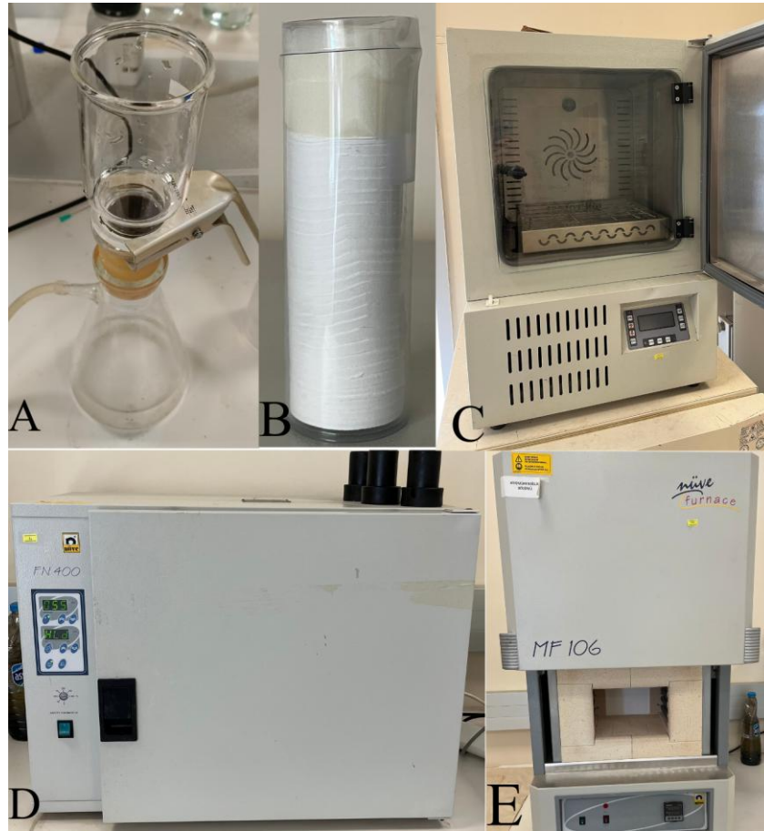
Şekil 3.8 a) Süzme Seti, b) Merck Millipore AP4004705 Cam Elyaf Filtre, c) Microtest İnkübatör, d) Nüve FN 400 Etüv, e) Nüve MF 106 Kül Fırını
