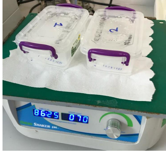
Şekil 13. Örneklerin aktarıldığı membranlara primer ve sekonder antikör işleminin gerçekleştirilmesi
