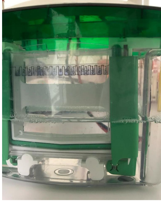
Şekil 12. Örneklerin jel elektroforezinde yürütülmesi
