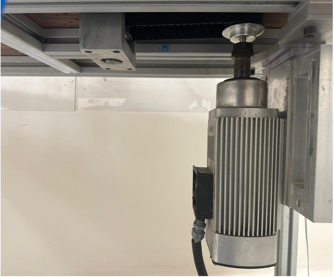
Şekil 3-3 Santrifüj Eğirme Mekanik Tahrik Sistemi
