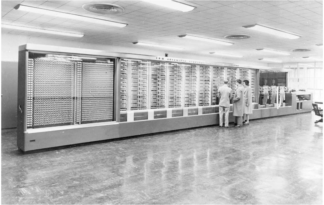
Görsel 7. Howard Aiken tarafından tasarlanan, 50 fitten (15 metre) daha uzun olan ve yaklaşık 750.000 bileşen içeren dev hesaplama makinesi, bilgisayar, Harvard Mark I ( https://www.britannica.com/technology/Harvard-Mark-I )
