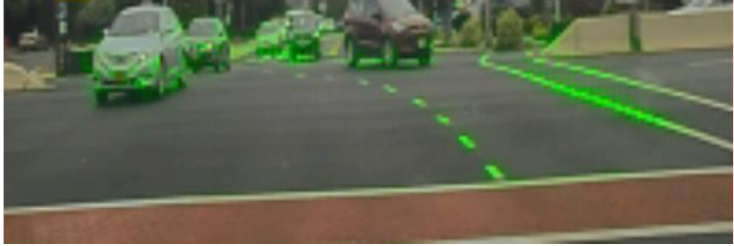
Görsel 25. Pilotnet kamera görüntüsü, yeşil renkli kısımlar onun şerit işaretlerini, yol kenarlarını ve diğer araçları tanımayı öğrendiğini gösterir (Bojarski, Muller, Firner vd. 2017)
