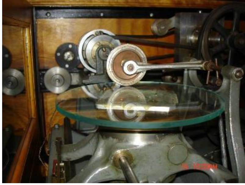
Görsel 1. MIT Müzesi'nde sergilenen Bush'un diferansiyel analiz cihazı tekerlek ve disk entegratörü görseli (Lundberg ve Pereverze, 2005)
