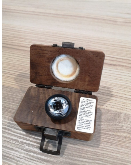
Resim 2.4: Zeiss Dört Aynalı Lensi
