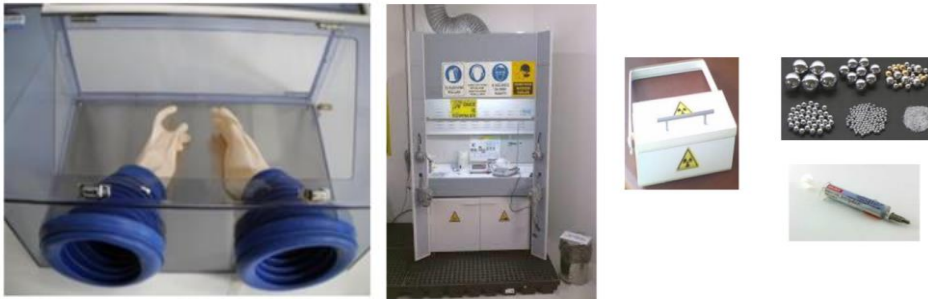
Resim 15. Glovebox, Kurşun Hücre Çeker Ocak, Kurşun Taşıma Kabı, Bilyeler, Enjektör
