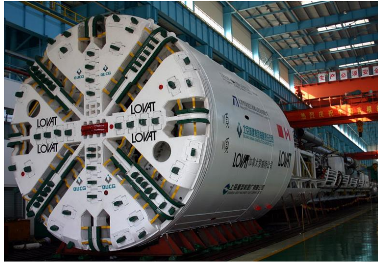
Şekil 2.26 Pekin Metrosunda kullanılan EPB makinası
