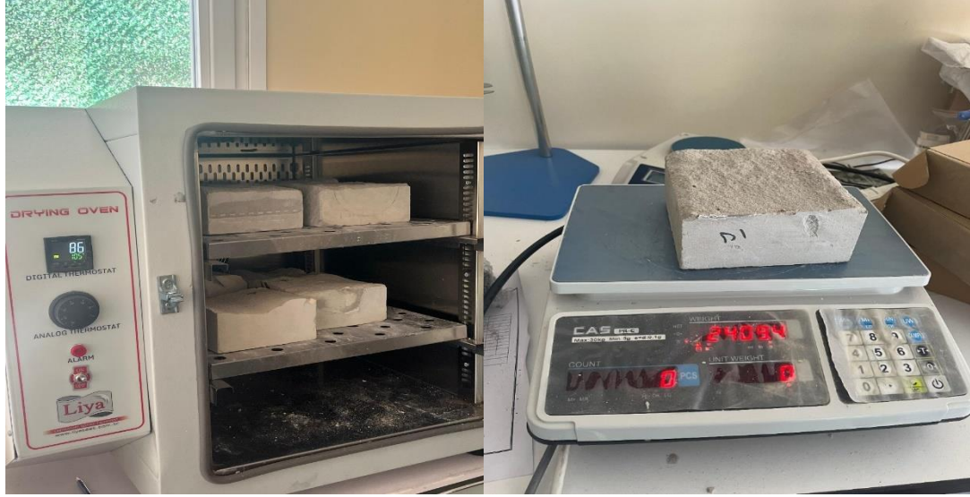
Şekil 18 Etüv Cihazı ve Numunelerin Tartılması
