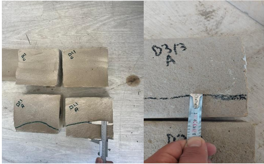
Şekil 16 Numunelere Nüfuz Eden Su Seviyesinin Belirlenmesi
