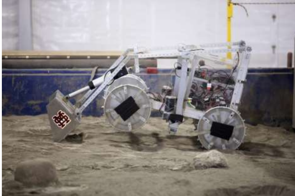
Şekil 10. RMC Kapsamında Mars Yüzeyi Benzetiminde Kazı Yapan Bir Araç
