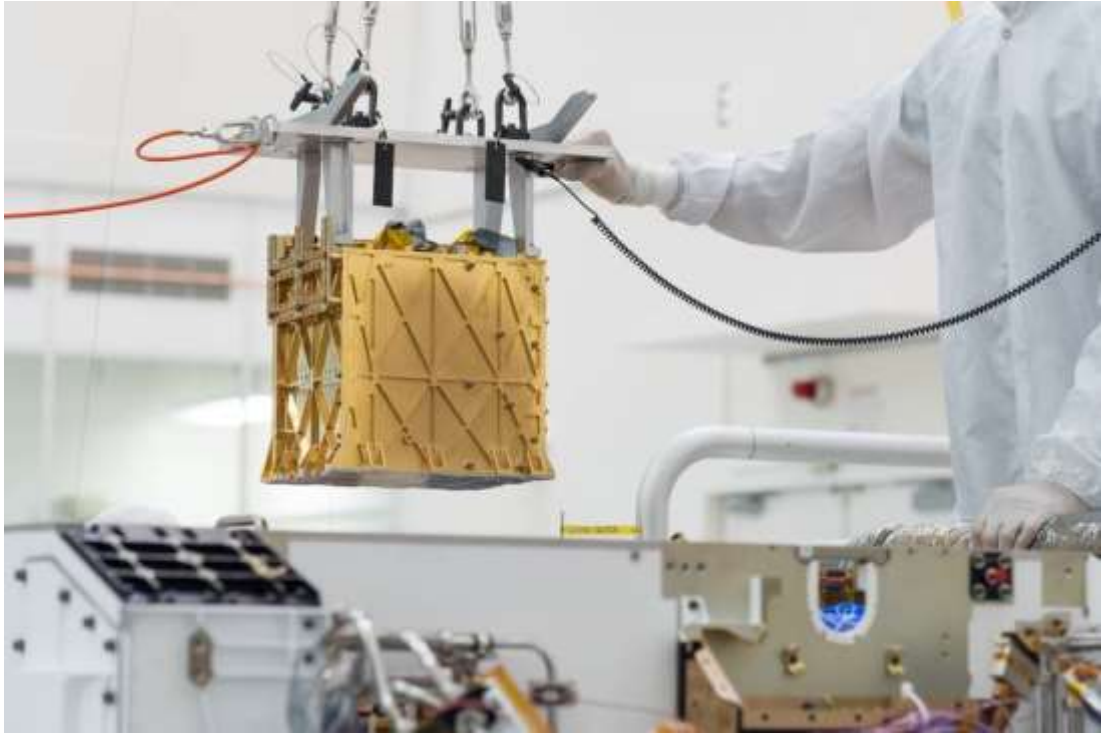
Şekil 14. Mars'ta Oksijen Üretmek İçin Geliştirilmiş Araç
