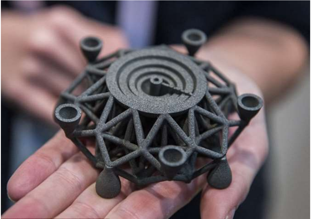
Şekil 17. Uzaydan Elde Edilmiş ve Planetary Resources Tarafından 3B Yazıcı İle Şekillendirilmiş Bir Metal
