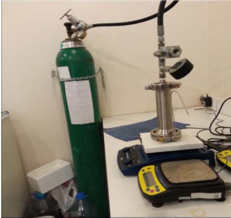
Fotoğraf 2. SRF ve SF analizlerinde kullanılan dead-end filtrasyon sistemi
