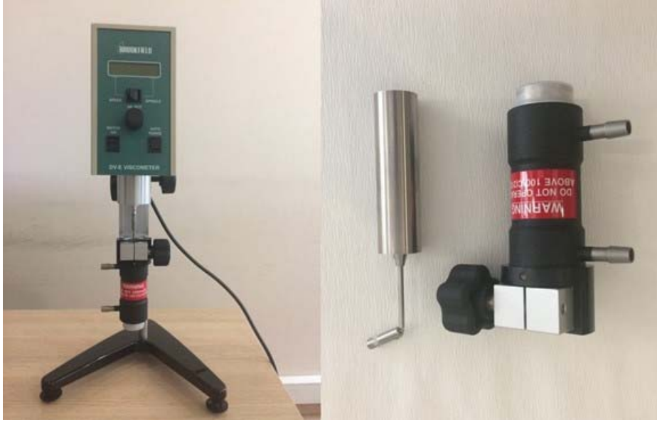
Fotoğraf 8. Çalışmadan kullanılan viskozitemetre ve kullanılan spindle (başlık)
