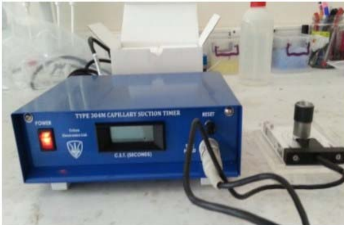
Fotoğraf 9. MBR performansına etkisinin araştırıldığı çalışmalarda kullanılan Capillary Suction Timer cihazı
