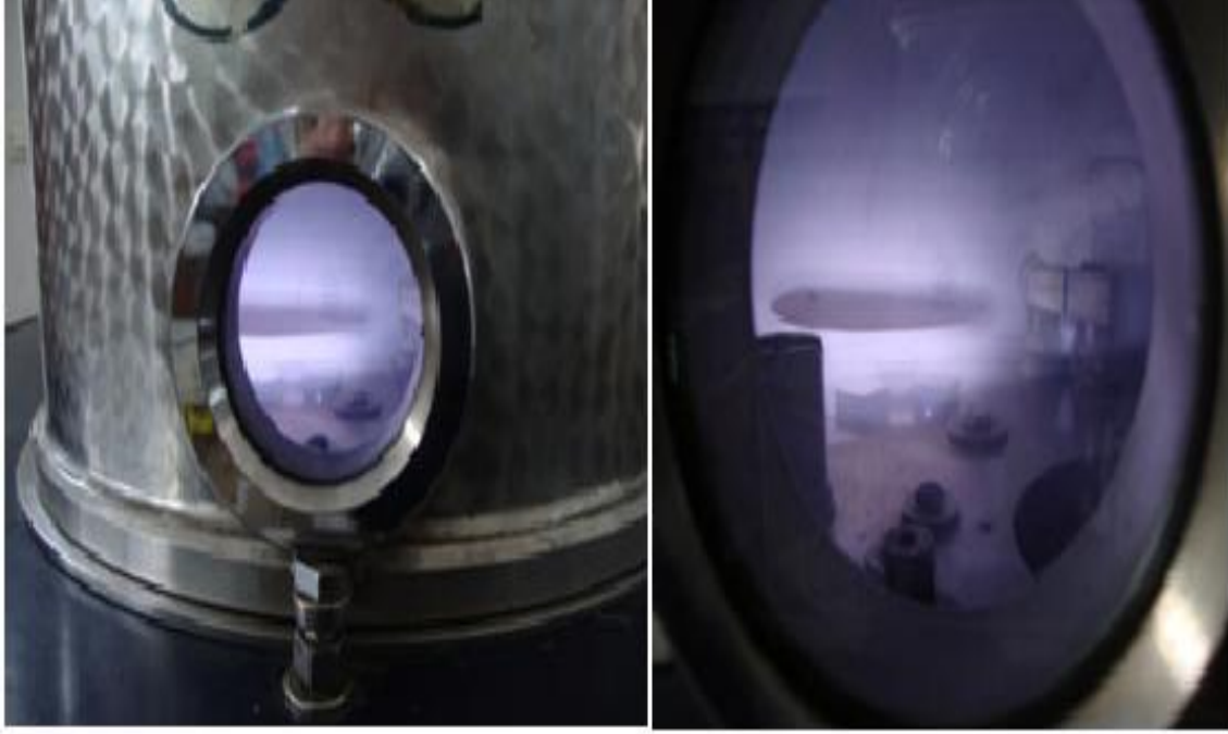
Şekil 5. Vakum şartlarında plazma kaplama işleminde kullanılan vakum çemberinin genel görünüşü
