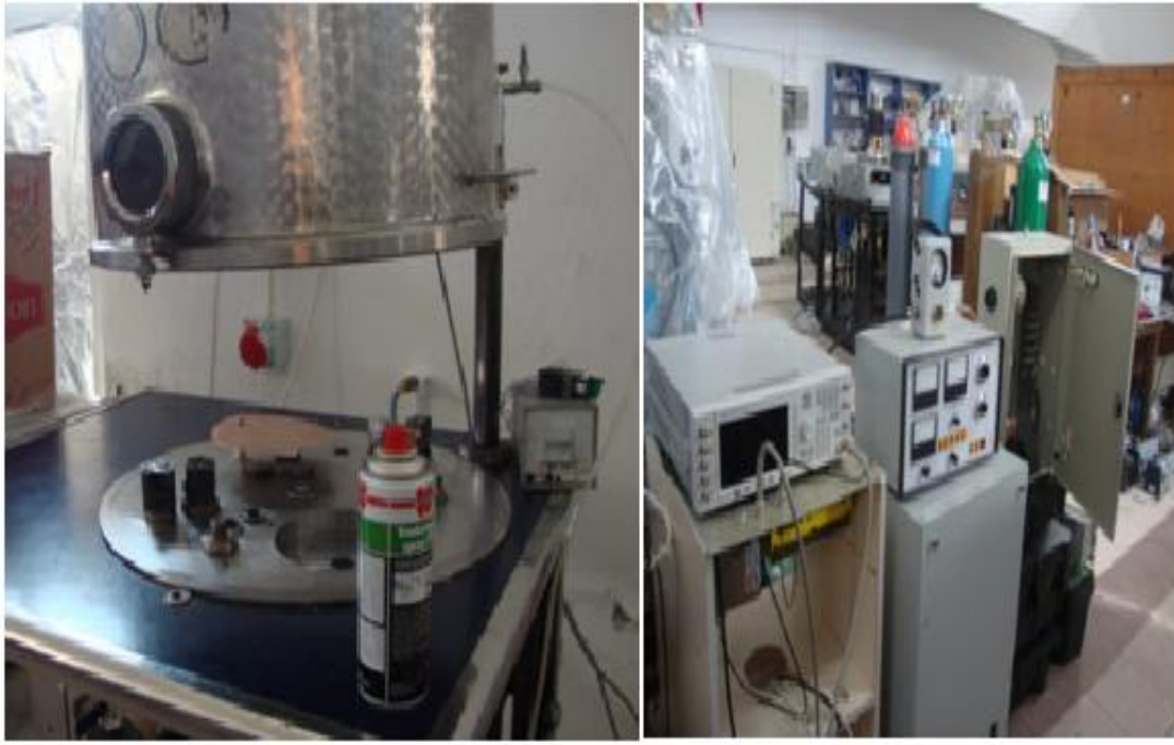
Şekil 6. PTFE vakum şartlarında plazma kaplama işlemi deney düzeneğinin işleme hazır halde genel görünüşü
