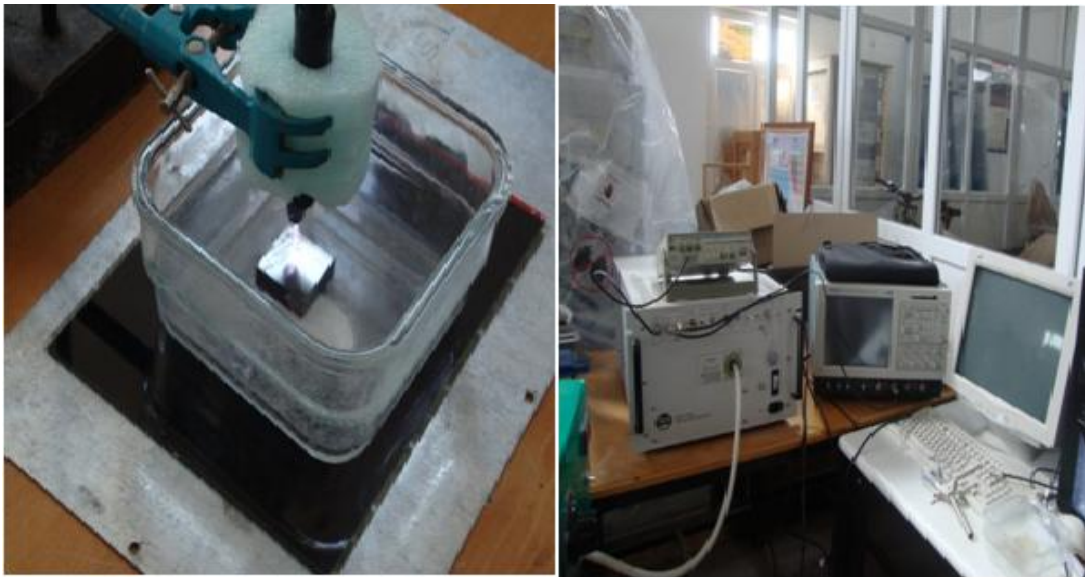
Şekil 3. Atmosferik şartlarda plazma kaplama işlemi deney düzeneğinin genel görünüşü
