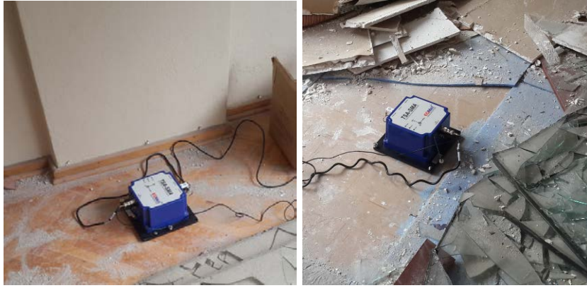
Şekil 91. Hasarlı bölgelere yerleştirilen ivmeölçerler
