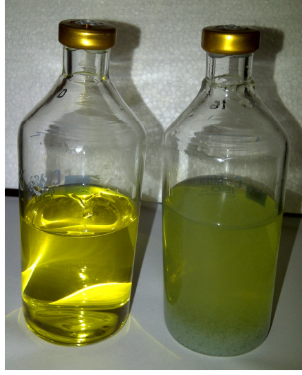
Fotoğraf 2. İkinci set kesikli reaktörlerin sülfür eklemenden önceki (soldaki) ve sonraki (sağdaki) görünüşleri
