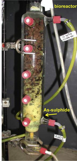
Şekil 3. Battaglia-Brunet ve ark. (2012) tarafından yapılan çalışmada reaktörde sarı renkli orpiment ( \text{As}_2\text{S}_3 ) birikimi
