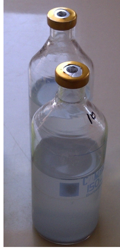
Fotoğraf 3. İkinci set kesikli reaktörlerin Cr(VI) indirgenmesi ve çökme sonucunda görünüşleri
